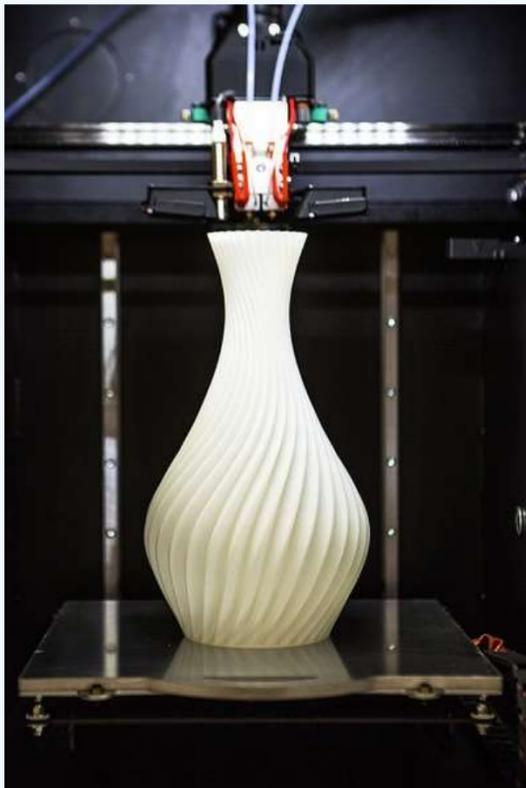
Nella modellazione a deposizione fusa (FDM o FFF), la costruzione del prototipo avviene mediante la deposizione allo stato fuso di una resina termoplastica (ABS, PC-policarbonato o ABS/PC-policarbonato) che in seguito sarà solidificata a strati per formare l'oggetto finito.
